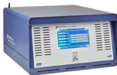
FIGURA 1 - Micro GC Fusion per analisi della qualità del biometano
